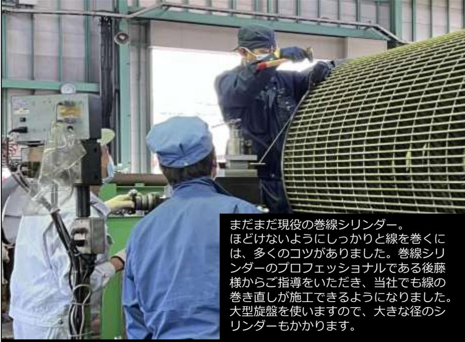
まだまだ現役の巻線シリンダー。ほどけないようにしっかりと線を巻くには、多くのコツがありました。巻線シリンダーのプロフェッショナルである後藤様からご指導をいただき、当社でも線の巻き直しが施工できるようになりました。大型旋盤を使いますので、大きな径のシリンダーもかかります。
