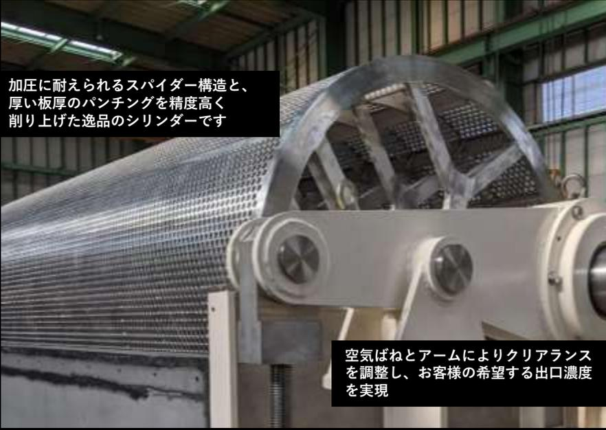
加圧に耐えられるスパイダー構造と、厚い板厚のパンチングを精度高く削り上げた逸品のシリンダーです
